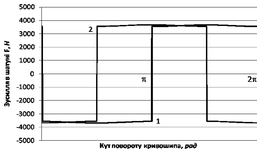
Рис. 5 – Графік зміни зусилля в шатунах F_1 (1) та F_2 (2) в залежності від кута повороту кривошипів
