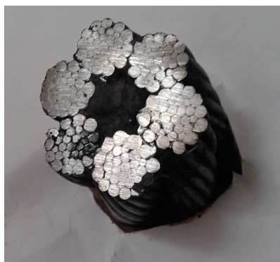
Рис. 3 – Сечение каната диаметром 32 мм после эксплуатации в течение нормативного срока службы
