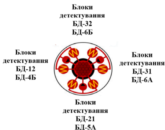
Рис. 4 – Розташування блоків детектування ССКГО БН-800 і БН-600
