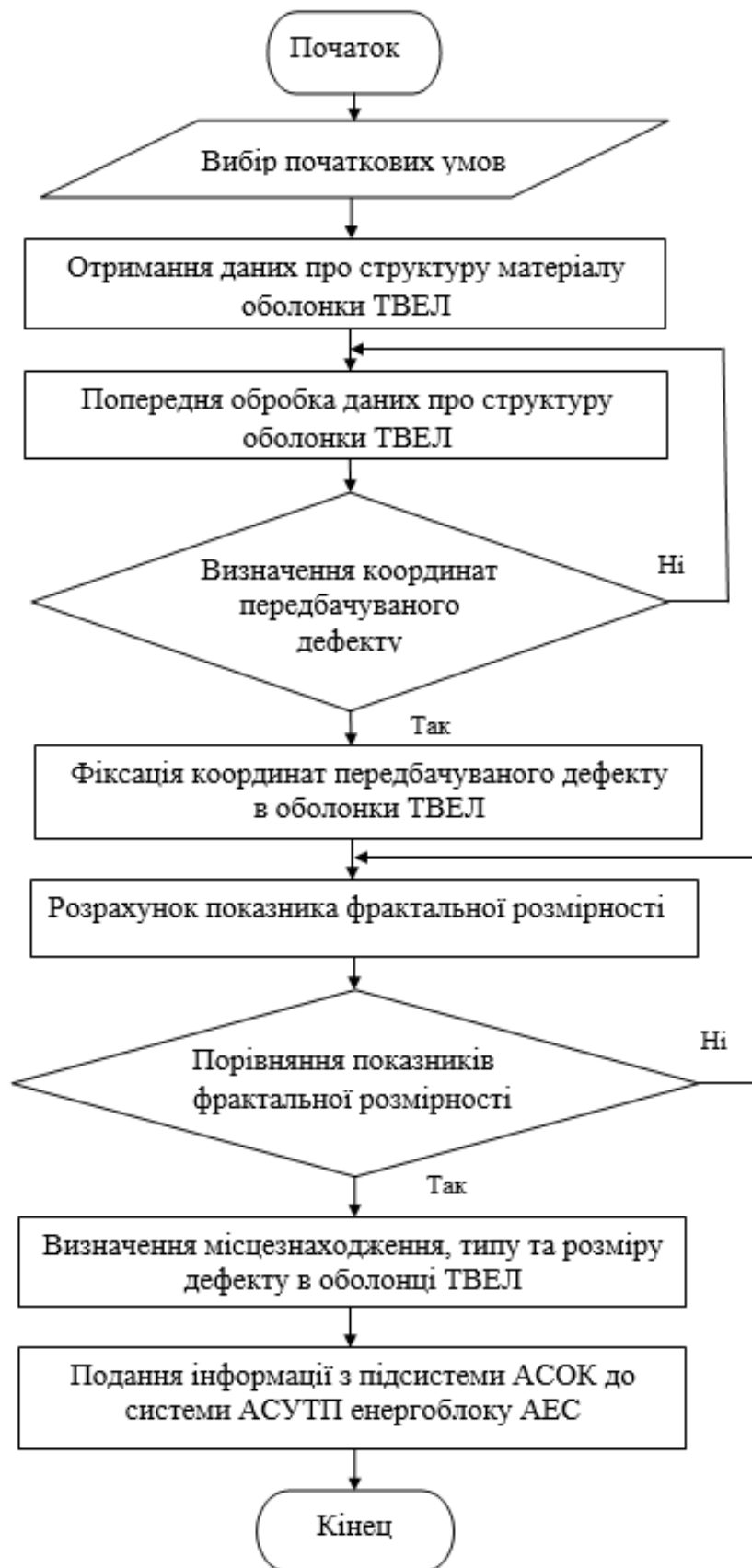
Рис. 9 – Блок-схема алгоритму застосування фрактального методу СКГО ТВЕЛ
