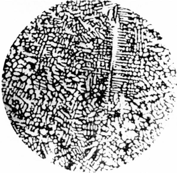
**Рис. 1** – Структура сплава 150X5Г9Т5С2, X350
